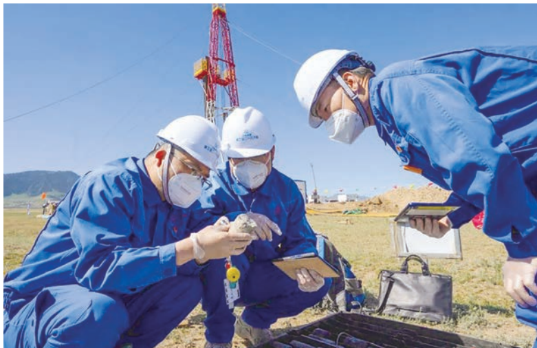
铀矿钻孔岩心编录工作现场
